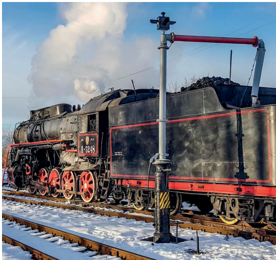
Фото 28. Паровоз заправляют водой из водокачки
